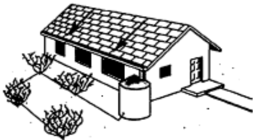
Sistema de recolha de água com captação pelo telhado, caldeiras e goteiras, armazenamento e sistema de distribuição gota-a-gota. Fonte: Departamento de Recursos Hidrográficos do Arizona. ©1998
